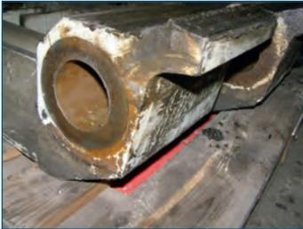
Sehr starker und gefährlicher Verschleiß in dem Klemmbackenbereich. Rost und Verschleiß in der Lagerbuchse.
