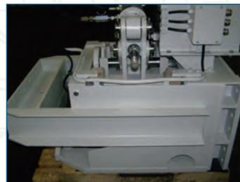
Alle Teile werden gereinigt und nach Bedarf auch sandgestrahlt. Nach der Reparatur werden alle Teile neu grundiert und lackiert und zum Schluss montiert.
