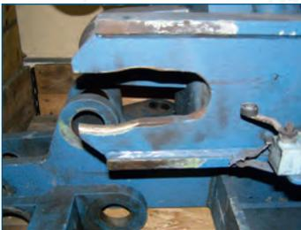
Sehr hoher Verschleiß im Zangengerüst, im Bereich des Führungsbolzens. Eine richtige Schließfunktion wird damit verhindert.
